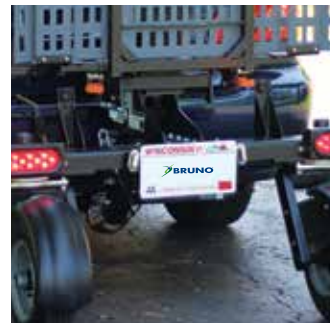
Soporte para matrícula con iluminación.
