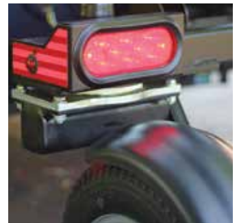
Luces de marcha, freno e intermitentes.
