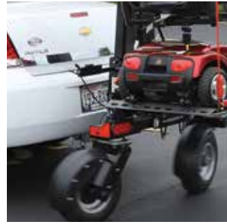
Ruedas giratorias, suspensión independiente.
