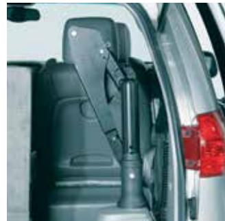
Los pernos de desbloqueo rápido permiten que se pliegue la cabeza de elevación
