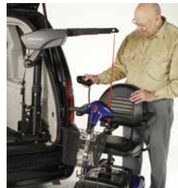
Elevación y descenso con motor eléctrico para utilizarlo sin esfuerzo.
